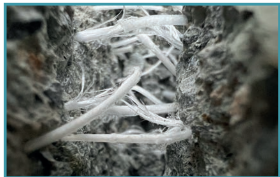
Megjelenés a lemeztörési vizsgálat után
